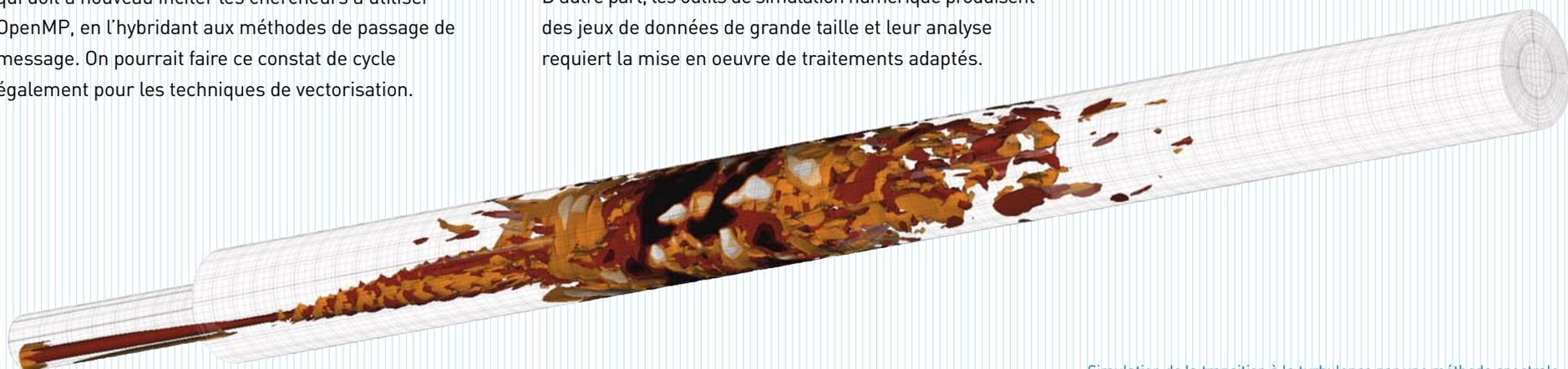
Simulation de la transition à la turbulence par une méthode spectrale, visualisation du champ de vorticité axiale dans un élargissement brusque. K. Selvam et J. Peixinho - LOMC UMR 6294 - CNRS et Université du Havre
