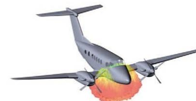
Simulation d'une antenne de radionavigation sur avion avec le logiciel CAPITOLE-RF
